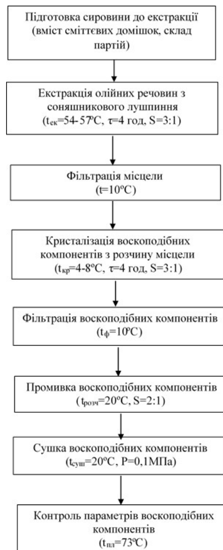
Рис. 3 – Принципова схема процесу видобування воскоподібних компонентів з лушпиння різних зразків
