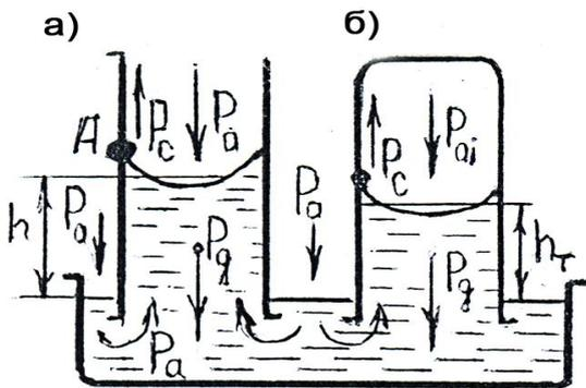
Рис. 4. Действующие силы при пропитке капилляров: а – сквозной капилляр; б – тупиковый капилляр, где  $P_a$  – атмосферное давление;  $P_c$  – капиллярное притяжение;  $P_g$  – вес жидкости;  $P_{ai}$  – противодействие газа в тупиковых порах
