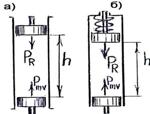
Рис. 5. Физическая модель пропитки : а – сквозной капилляр, б – тупиковый капилляр, где  $P_{mv}$  – движущая сила;  $P_R$  – реактивная сила.
