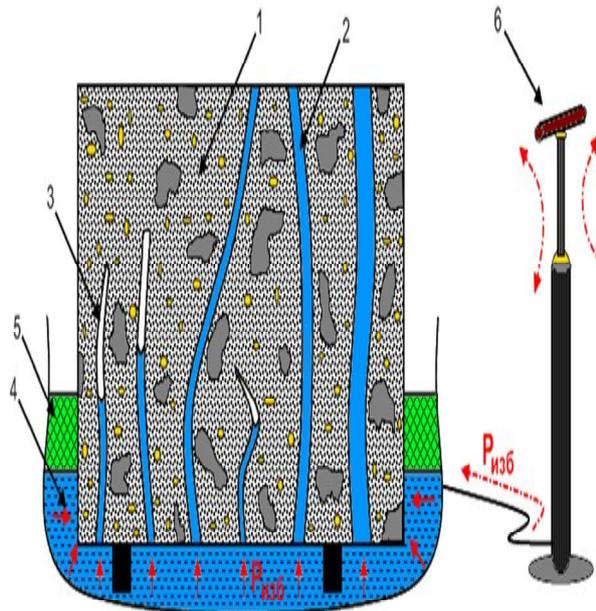
Рис. 3. Односторонняя подача жидкости под давлением : 1 – бетонное изделие; 2 – сквозной капилляр; 3 – тупиковый капилляр; 4 – пропитывающая жидкость; 5 – гидроизоляция; 6 – насос.
