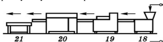
Рис. 12. I – лінія для виробництва брикетного морозива на вафлях: —○— фризери суміш; 18 – фасувально-дозувальний автомат брикетного морозива; 19 – загортальний автомат; 20 – швидкозаморожувально-загортальний апарат; 21 – стіл
