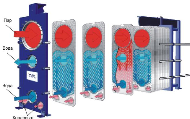
Рис. 12. Принцип роботи пластинчастого конденсатора AlfaCond.
